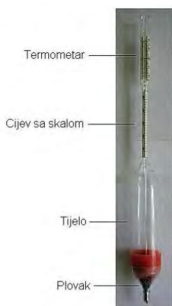
Slika 1. Laktodenzimetar za mjerenje gustoće mlijeka
