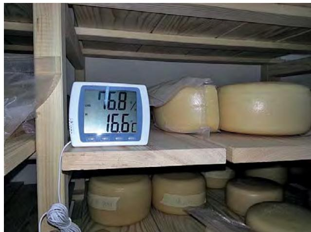
Slika 1. Termohigrometar za praćenje relativne vlažnosti zraka u prostoriji za zrenje sira
