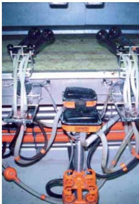
Slika 2: Dvije muzne jedinice sa automatskim skidanjem sisnog sklopa
